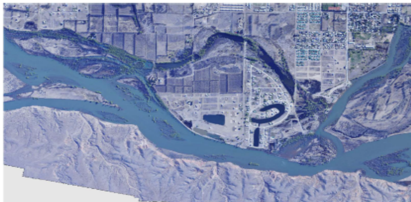
Imagen 9: Vuelo río Limay 13 de septiembre de 2013. Caudal 1290 m 3 /s, línea de ribera.
