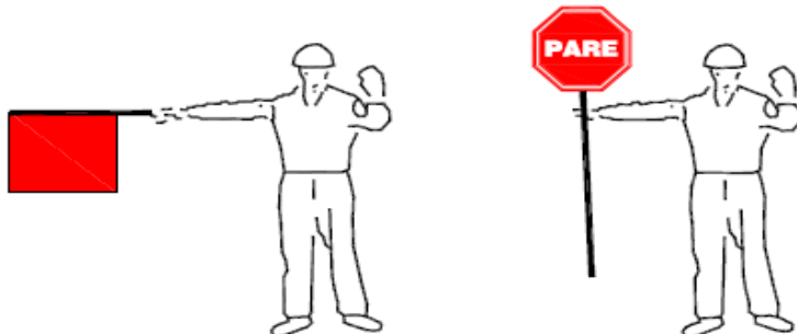
SEÑAL PARA DETENER EL TRANSITO
